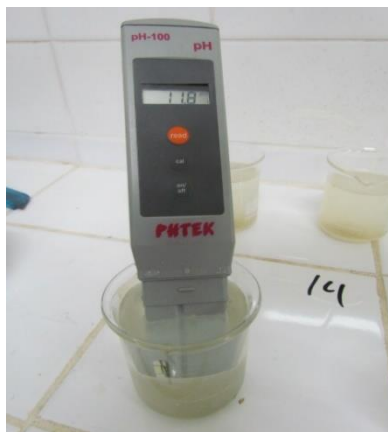
Figura 2. Aferição de pH na água de construção com a aplicação de sementes de moringa em diferentes formas.
