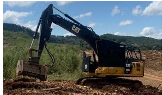
Figura 1 – Escavadeira Pesa 320D2 FM com Roder UMM EX VT.
