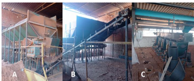
Figura 5: Máquina responsável pelo abastecimento da fonte energética: (A) local onde é adicionado a fonte energética, (B) percurso e (C) adição da fonte energética nos fornos contínuos da indústria 3. Fonte: os autores.
