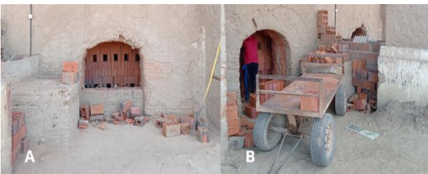
Figura 10. Abertura da estufa (A) e retirada dos produtos (B) na indústria 2. Fonte: os autores.
