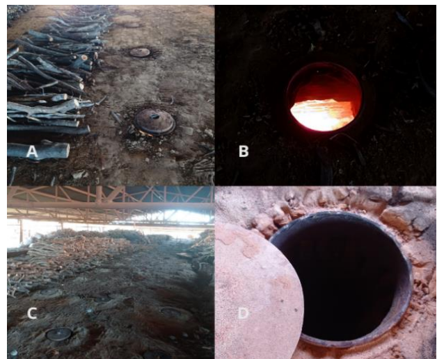
Figura 4: Organização da fonte energética na indústria 1 (A) e 2 (C) e o local onde é adicionado a lenha para a queima na indústria 1 (B) e 2 (D). Fonte: os autores.
