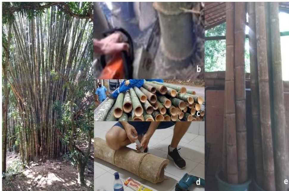
Figura 1 - Processo de colheita, transporte e tratamento dos bambus: a) Touceira; b) Colheita; c) Transporte; d) Tratamento por injeção de solução; e) Tratamento substituição de seiva.
