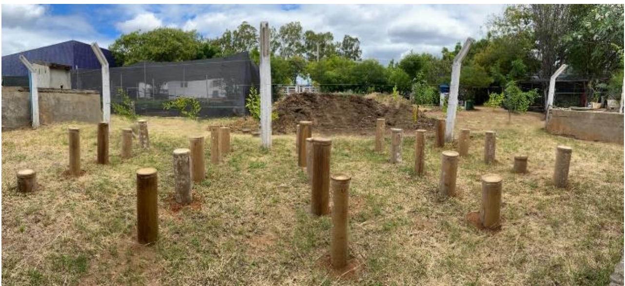
Figura 4 – Campo de apodrecimento de bambu instalado na UFERSA.
