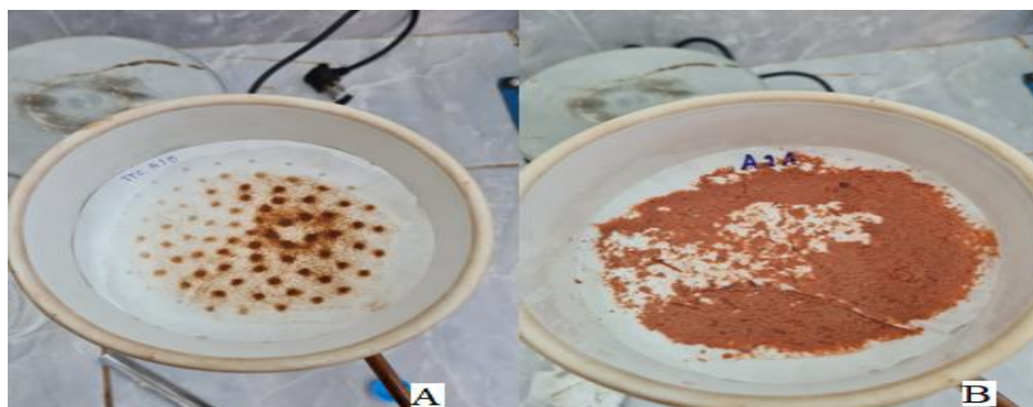
Figura 2 - Processo de filtração da solução de formaldeído e ácido clorídrico com o precipitado de galhos de Mimosa tenuiflora (Willd.) Poir e Prosopis juliflora (Sw.) DC. Legenda: "A" precipitado de Prosopis juliflora ; "B" precipitado de Mimosa tenuiflora Fonte: Dados da pesquisa (2024)
