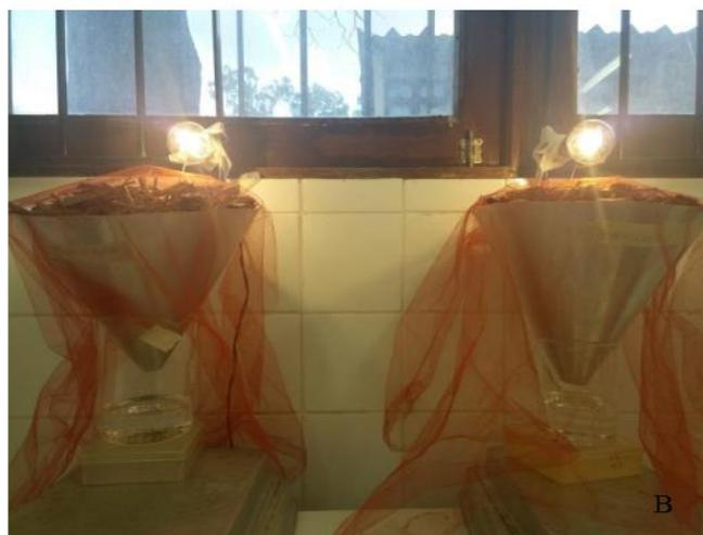
Figura 1 - Esquema da estrutura montada com o Funil de *Berlese-Tüllgren*.
